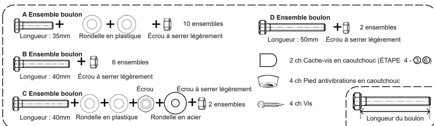
\* Pendant l'assemblage, faites attention aux côtés coupants comme le coin de la plaque transversale. Un tournevis et une clé de 10 mm (13/32 pouces) sont nécessaires au montage de The Bike Shield.
