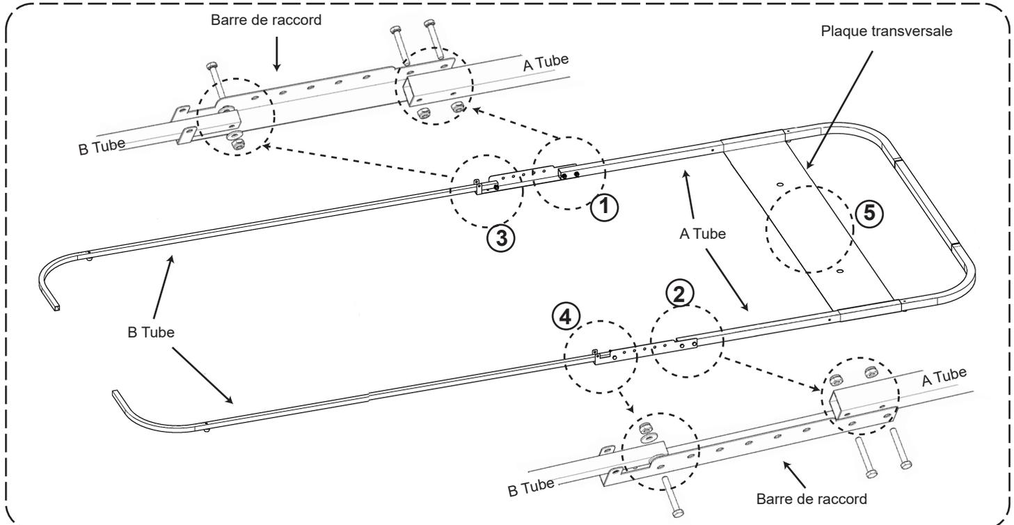
\* Tous les boulons doivent être insérés de l'extérieur vers l'intérieur de The Bike Shield.
