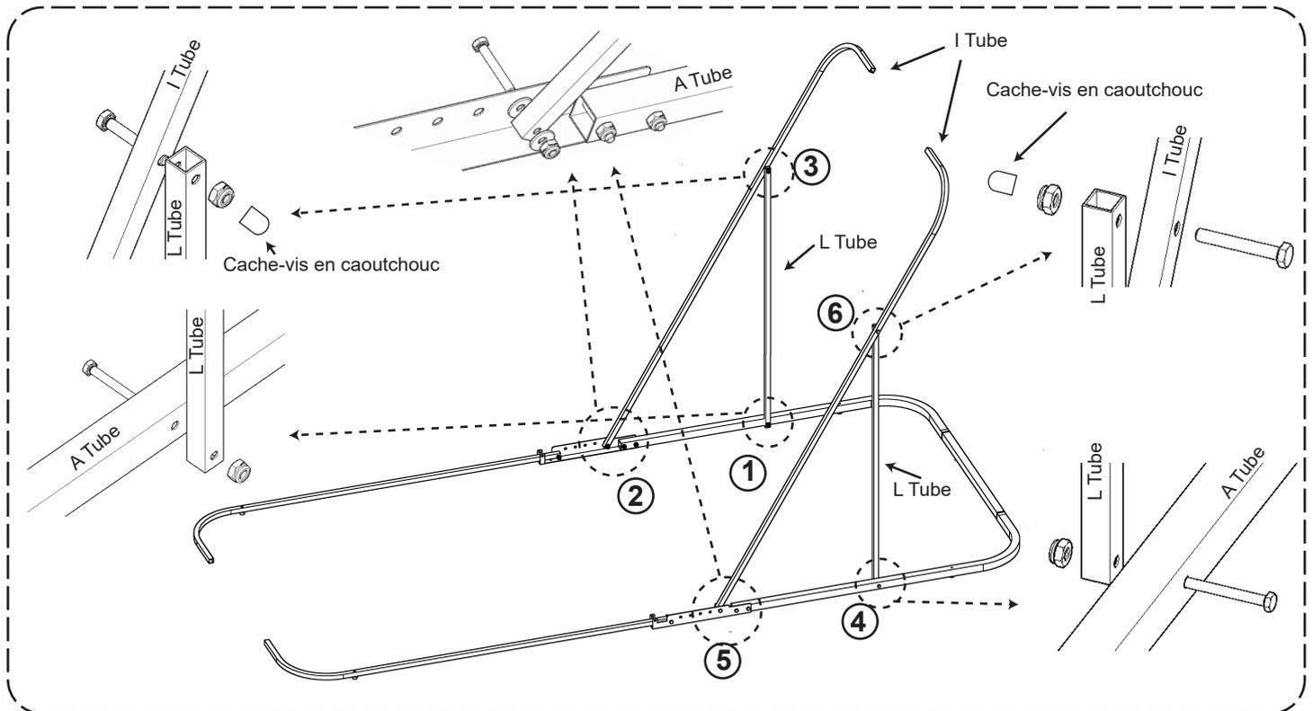
\* Tous les boulons doivent être insérés de l'extérieur vers l'intérieur de The Bike Shield.
