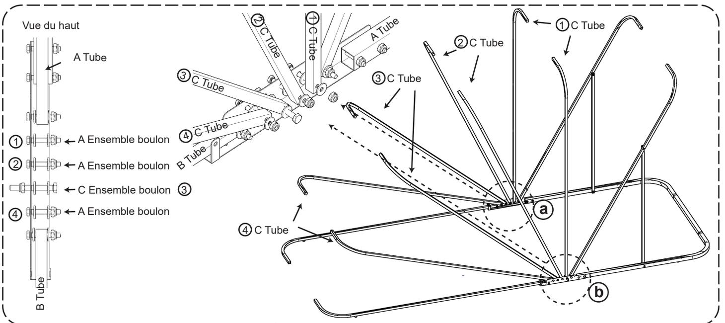
①, ②, ③, ④ Assemblez les 4 C Tubes du côté gauche à l'aide de la barre de raccord.
