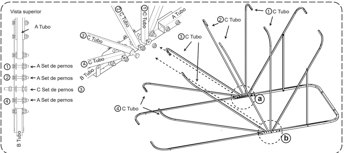
a) Juntar cuatro ①, ②, ③, ④ C Tubo con la barra de unión izquierda.
