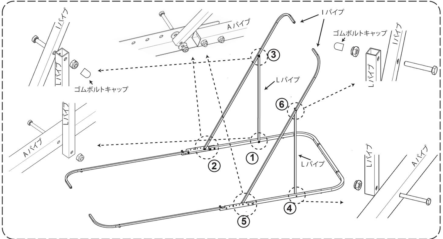
\*ボルトはパイプフレームの外側から内側に向けて取り付けます
