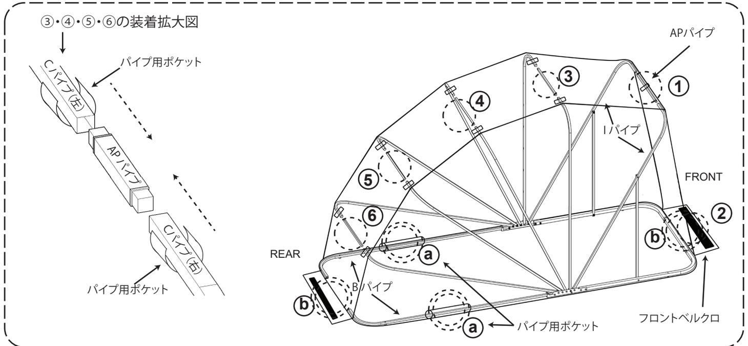
①カバーの表裏を確認。図のように「Bパイプ用ポケット」の2個の位置を確認してください。
