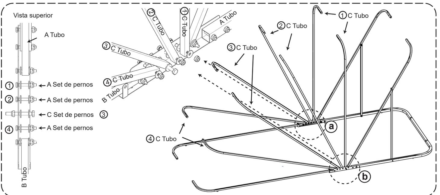
① Juntar cuatro ①, ②, ③, ④ C Tubo con la barra de unión izquierda.
